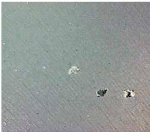
▲ شکل ۳. نمونه سطح ماشین کاری شده لوله سالم (بدون شکاف)
