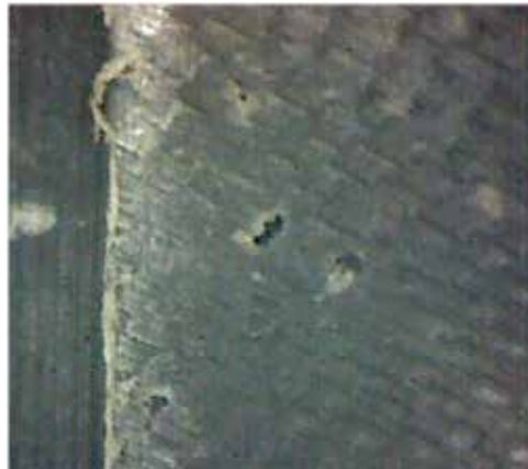
▲ شکل ۲. نمونه سطح ماشین کاری شده لوله ترک خورده (شکسته)
