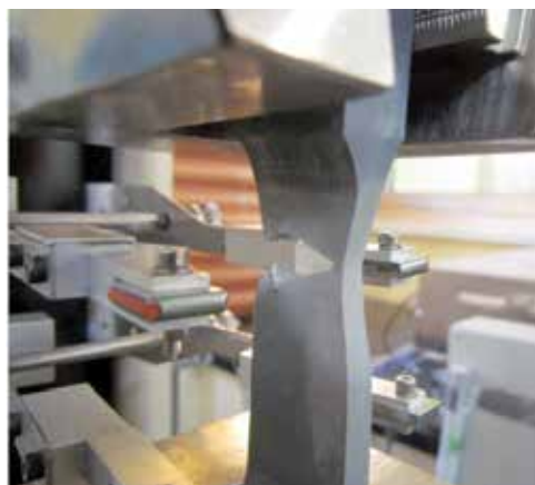
▲ شکل ۴ نمونه کشش شکست زودرس لوله ترک خورده نمونه ۸
