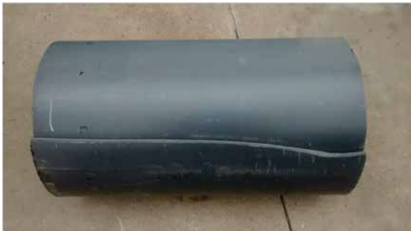
▲ شکل ۱۲. نمونه لوله با ترک طولی
