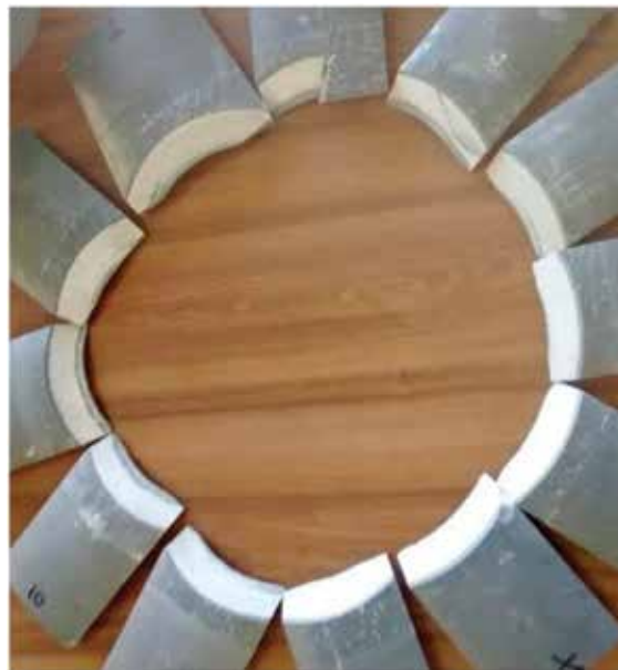
▲ شکل ۱۶. نمونه DCM (نمونه لوله شکسته)
