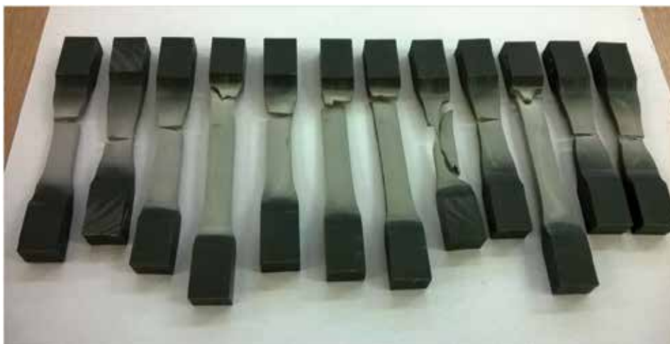
▲ شکل ۱۳. نمونه تست کشش پس از آزمایش
