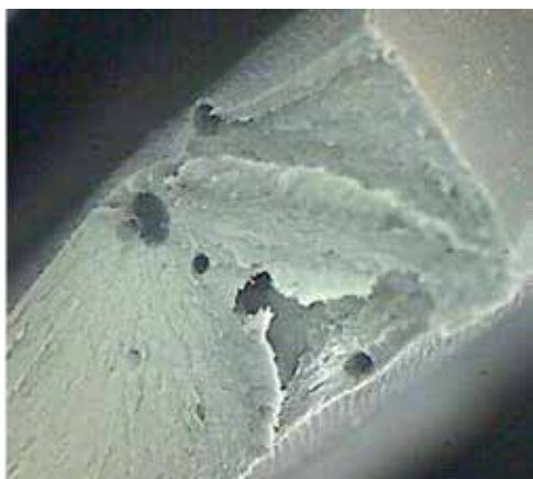
▲ شکل ۵ نمونه کشش شکست زودرس لوله ترک خورده نمونه ۸
